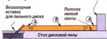
Рис. 3. Обработка продольных кромок рамки.
