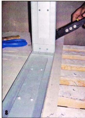
7 При соединении отдельных элементов использовал уголок. Двух рук при сборке часто не хватало.
