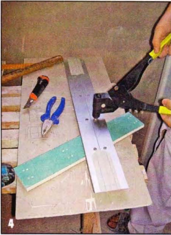
4 Детали рамы соединял на заклёпках с отрываемым стержнем.
